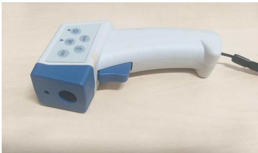
Figura 4.4 Representação esquemática de um termômetro com sensor de radiação térmica.
